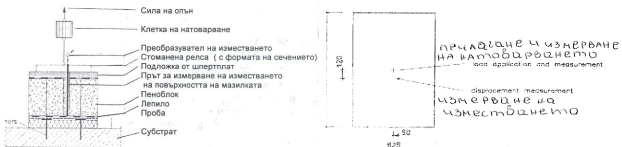
Фиг.8: Схема на изпитването по „Метод с пеноблок”
